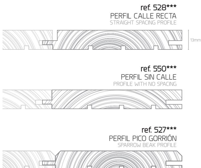
\* Los perfiles de ancho 120mm sólo están disponibles en espesor 13 mm y 17 mm. / 120 mm wide profiles are only available in 13 mm and 17 mm thickness.
